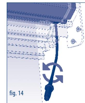
Qualora sia necessario regolare la carica della molla è possibile mediante la chiave di regolazione in dotazione.
