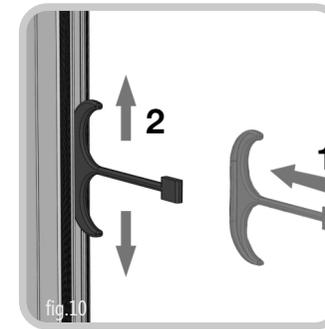
verificare il canale di scorrimento, se il movimento non risulta fluido controllare il serraggio delle viti.
