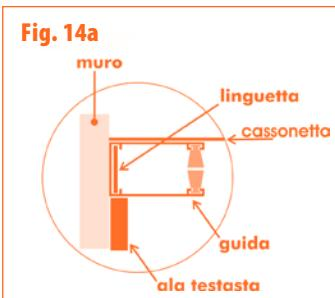
**14. Posa in opera delle guide.** L'estremità superiore della guida va posizionata tra l'ala della testata e la sporgenza posteriore del cassonetto, (fig. 14) in modo che la linguetta in nylon si inserisca nella guida (fig. 14/a). Gli estremi inferiori (quelli con i ganci di fondo, fig. 7) devono poggiare sulla soglia. Con le guide in posizione perpendicolare, segnare sul muro i fori di fissaggio. Bloccare con gli stop in dotazione.
