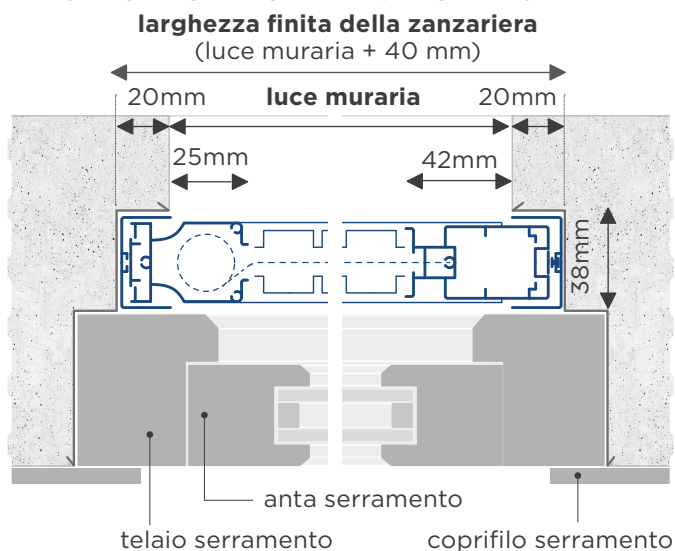
SEZIONE ORIZZONTALE VANO FINESTRA
